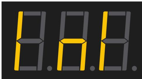
**AqC** = Aquecendo: Aqui, o controlador está aquecendo a resistência da sonda para começar a leitura. Ao ligar o carro pela primeira vez, frio, este processo pode demorar até 20s.
