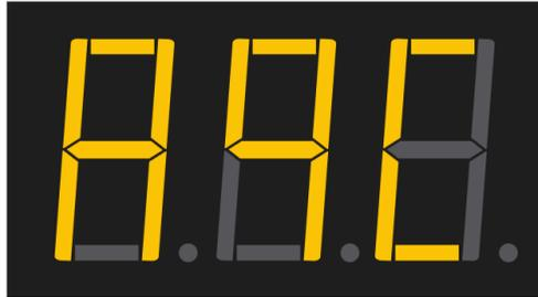
**Err** = Erro: Quando encontrar-se neste estado, pode haver mau contato no conector ou problemas no controlador. Retire ambos os conectores e insira novamente, caso a mensagem persistir, entre em contato com o suporte técnico.
